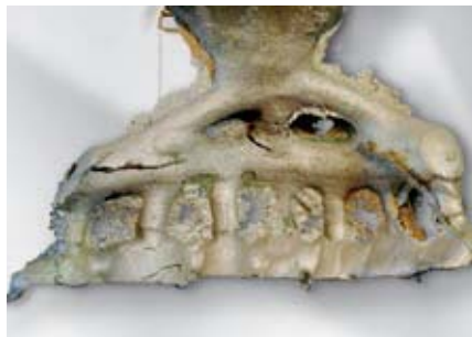
Fig. 1 - Sbavature del metallo
