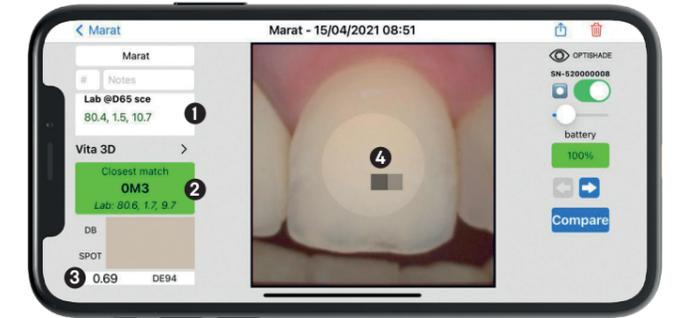
Le informazioni sul display del telefono sono molto chiare e mostrano sempre le coordinate L\*a\*b\* del dente misurato rispetto ai valori della scala colori riconosciuta più vicina nel database.
